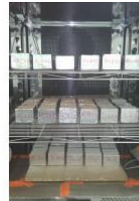
Dispositif expérimental pour la mesure : (a) de la conductivité thermique et (b) du MBV
