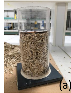
Mesure de la masse volumique: (a) apparente, (b) du squelette.
