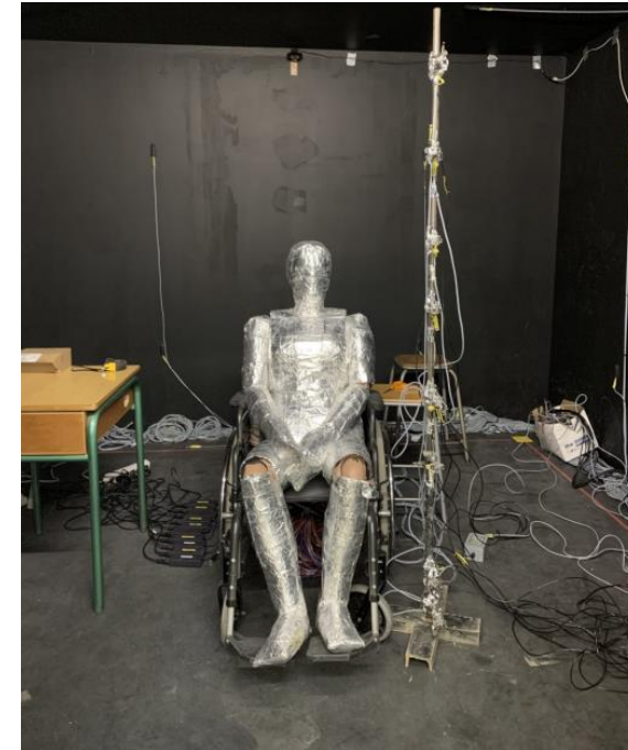
Mannequin thermique humanoïde respirant du LGCGM Selon norme BS EN ISO 14505
