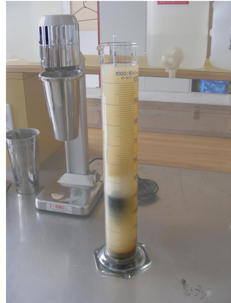
Mesure de granulométrie par sédimentométrie
