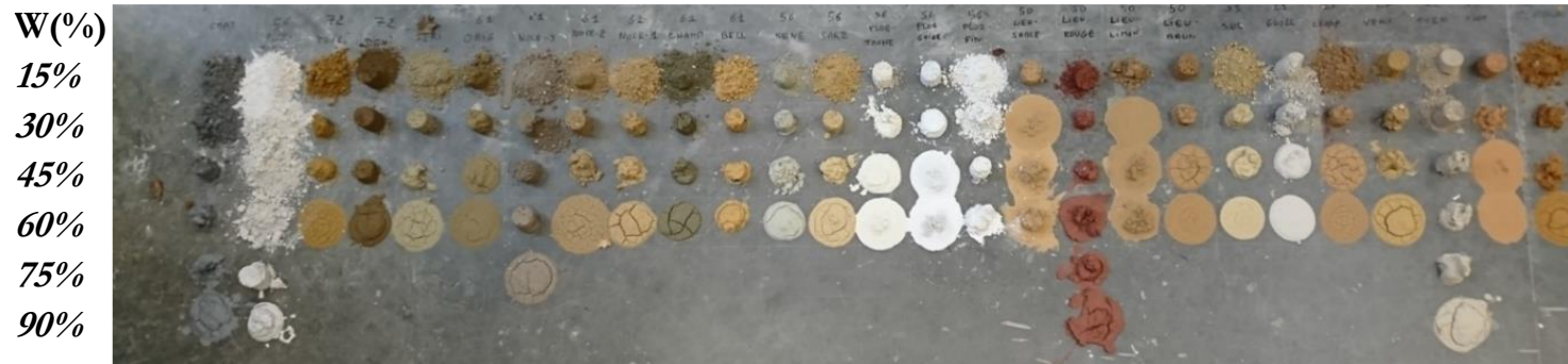
Matrice de consistance inspirée du "test Carazas" réalisée sur 28 terres bretonnes et normandes différentes (Crédit photo : Théo Vinceslas)
