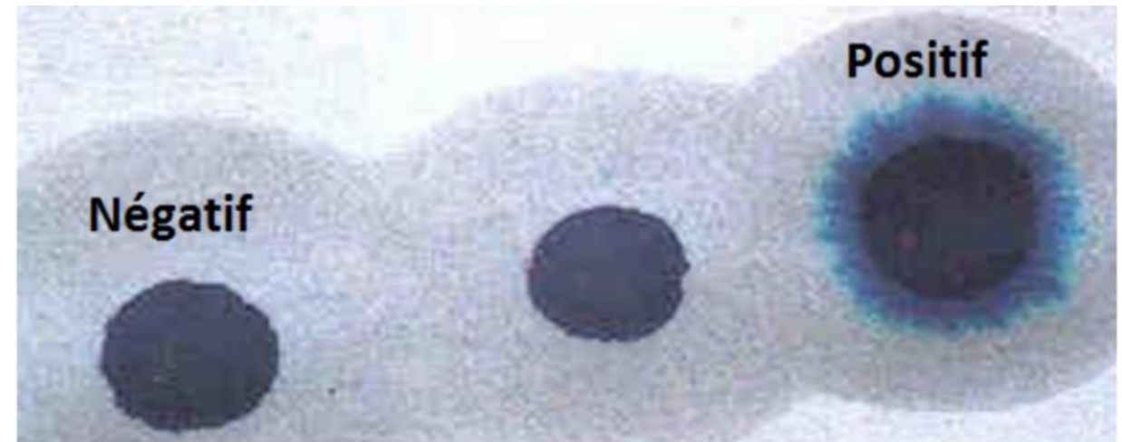
Détermination de la valeur au bleu de méthylène du sol théorie(a), taches de bleu de méthylène sur papier filtre(b)
