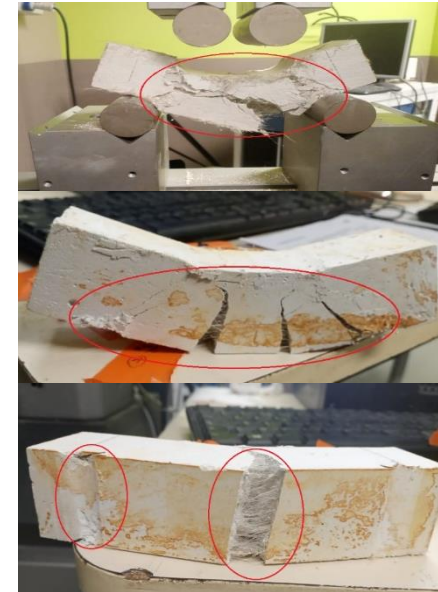
Mode de rupture des composites renforcés par des fibres de lin
