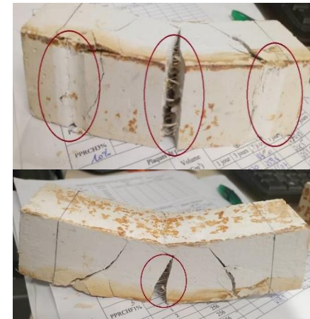
Mode de rupture des composites renforcés par la chènevotte fibrée
