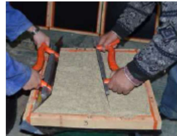
Fabrication de plaque d'enduits
