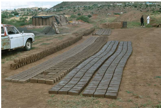
Adobes : blocs de terre moulée et séchées
